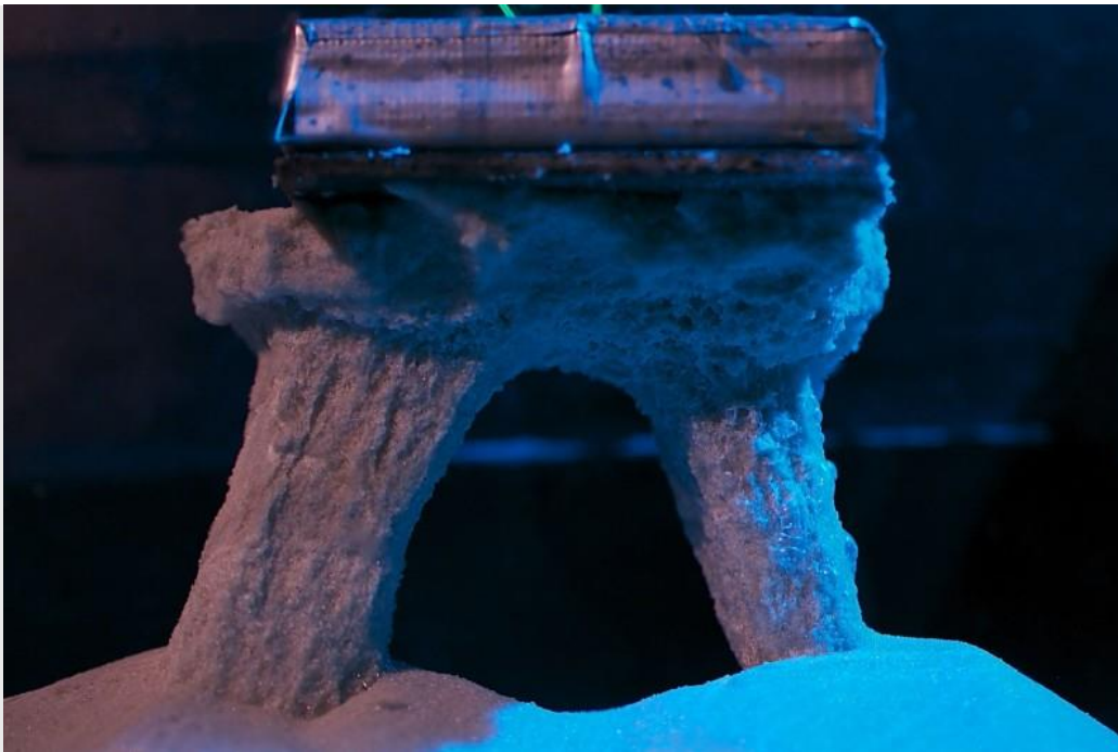
Unikátní pískovec (respektive uzamčený písek) ze Střelče, závaží, a záměrně vytvořená porucha (kamenný kvádr je podložen jen na krajích) mají společně za následek „spuštění“ článkem popisovaného procesu a tedy vznik skalní brány. (Foto: Marek Janáč)
